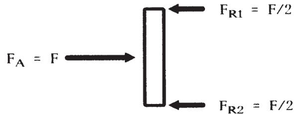
Bild 5: Aktions- und Reaktionskraft
