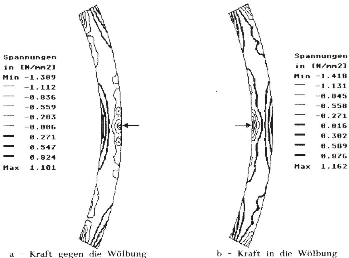
Bild 12: Spannungen in der Scheibe
